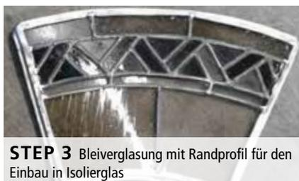
**STEP 3** Bleiverglasung mit Randprofil für den Einbau in Isolierglas
