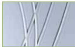
Rillenschliff – für lichtbrechende Vertiefungen
